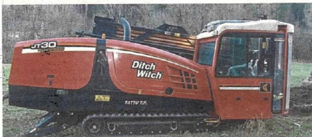
Des forages dirigés, prévus pour traverser le Lot, dans le cadre des travaux d'enfouissement des réseaux électriques HTA sur le bourg de Balsièges sont en cours de réalisation. Ce chantier de 270 000 euros, financé par Enedis, a débuté en septembre et devrait s'achever en début d'année 2017. L'objectif est de moderniser les structures électriques afin de faciliter l'exploitation et de fiabiliser l'alimentation du bourg.
